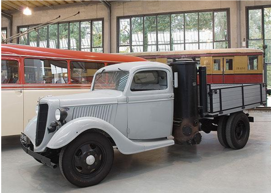
Camión liviano con gasificador de madera
